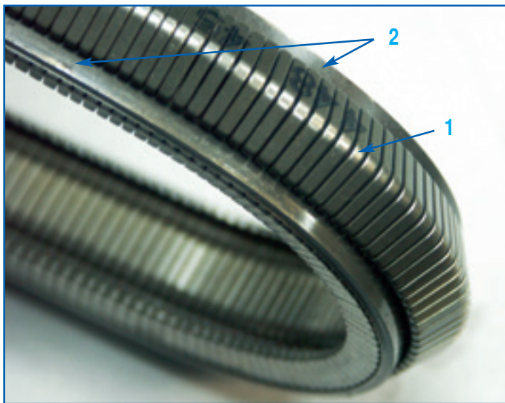
Толкающий ремень сформирован из стальных пластин трапецевидной формы (1), прочно стянутых в замкнутый пакет двумя многослойными металлическими лентами (2).
