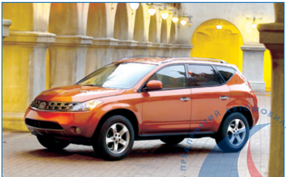
Nissan Murano — первый автомобиль, у которого мощный мотор VQ 35 DE с крутящим моментом 318 Н•м работает совместно с вариаторной CVT с толкающим ремнем.
