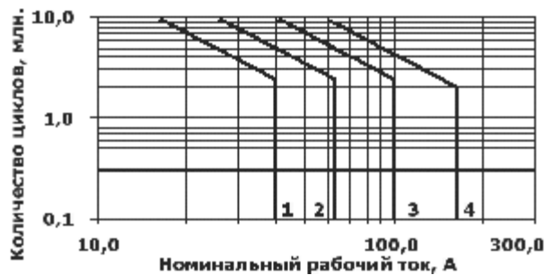
Рисунок 1. Зависимость коммутационной износостойкости пускателей серии ПМА (1 – ПМА-3000, 2 – ПМА-4000, 3 – ПМА-5000, 4 – ПМА-6000) от величины нагрузки
