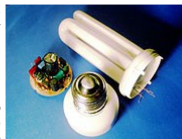
фото 2 Составные части лампы
