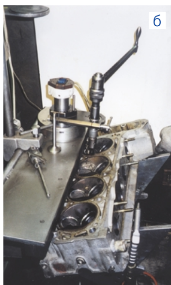
Специализированный станок для ремонта ГБЦ — вещь дорогая и применяется обычно при «серийном» ремонте (а). При небольших объемах ремонта достойная альтернатива — специализированные приспособления с ручным приводом (б).
