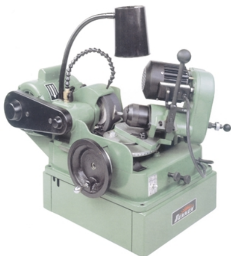
Фаски и торцы клапанов лучше всего обрабатывать на специализированном шлифовальном станке.
