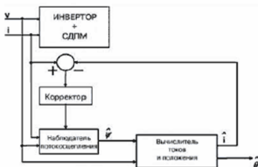
Рис. 12. Структурная схема вычислителя положения ротора ВД
