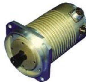
Рис. 1. Вентильный двигатель ВД-300 мощностью 7,5 кВт (ОАО «КБ ПА», г. Ковров), используется в качестве исполнительного элемента в быстродействующих следящих приводах специального и общепромышленного назначения
