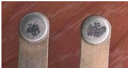
Рис. 2 - Вид контактов электромагнитного реле, проработавшего некоторое время
