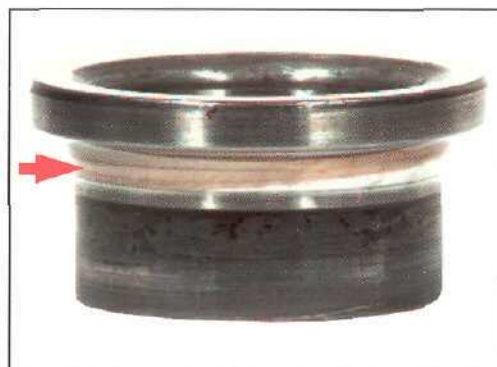
Широкий след траектории по всему диаметру дорожки качения.
