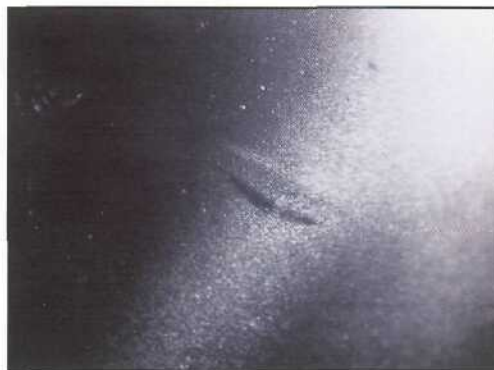
След деформации на шарике.
