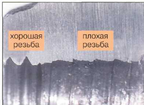
Срез гайки с поврежденной резьбой.
