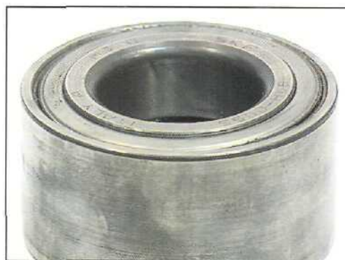
Уплотнение смещено из-за неправильной установки при монтаже в ступицу.
