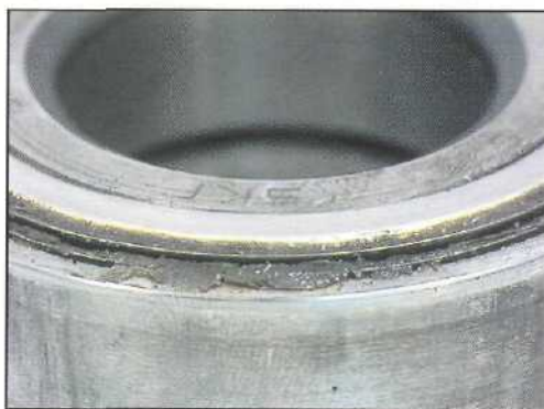
При увеличении видны следы утечки смазки.
