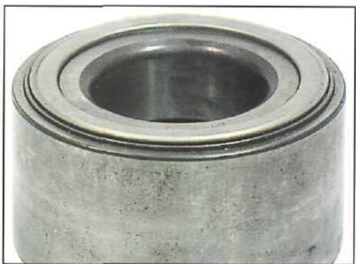
Уплотнение выступает над кольцами из-за неправильной установки.
