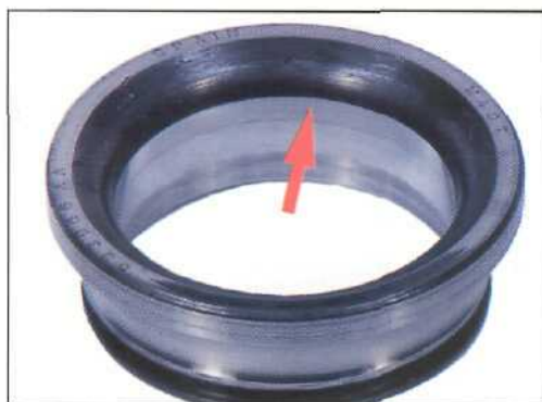
Признак проворота внутреннего кольца относительно оси из-за слабой посадки.
