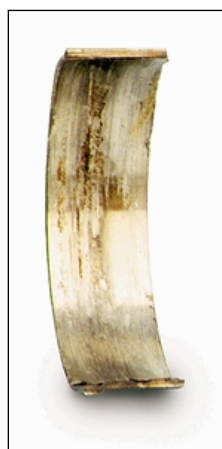
«Убитый» шатунный вкладыш – типичная причина стука под нагрузкой.
