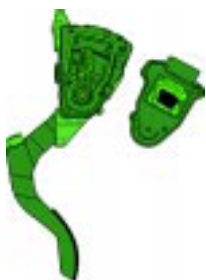
Датчик положения педали акселератора G79/G185
