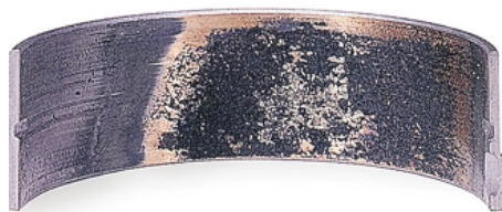
Коррозия вкладыша характеризуется изменением цвета и раковинами до основного антифрикционного материала.
