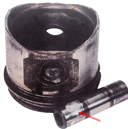
Схватывание пальца в отверстии боышек поршня произошло сразу после запуска двигателя. Причина — малый зазор в соединении и недостаточная смазка.
