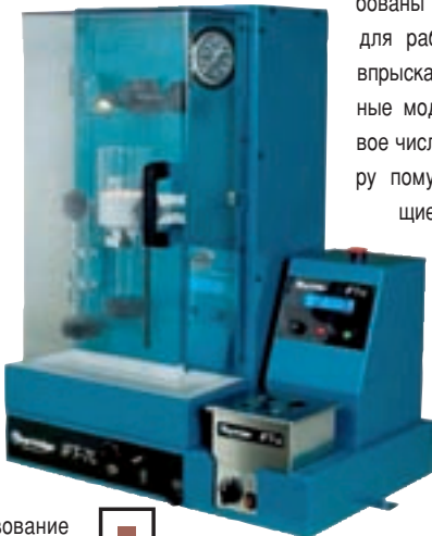
Стенд Hartridge IFT-70 сочетает доступную цену и исключительные функциональные возможности испытания любых форсунок.
