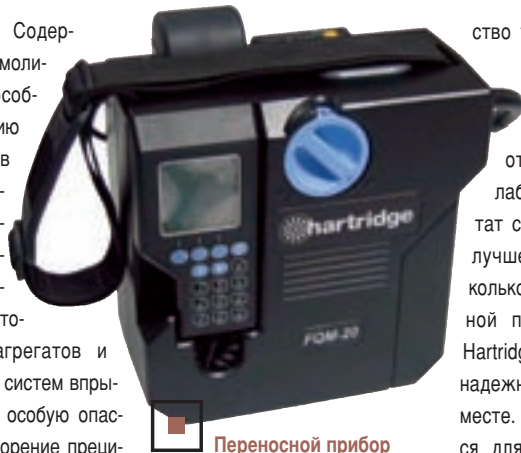
Переносной прибор FQM-20 фирмы Hartridge за 2 минуты проверяет качество топлива.
