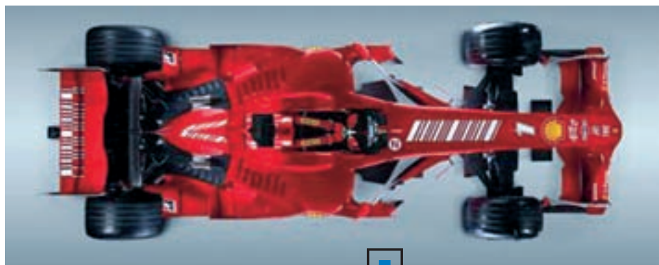
Для болида Ferrari F2008 износ колес — дело десятое, чего нельзя сказать об отзывчивости рулевого управления (вперед — toe-out) и компенсации избыточной поворачиваемости (сзади — toe-in).
