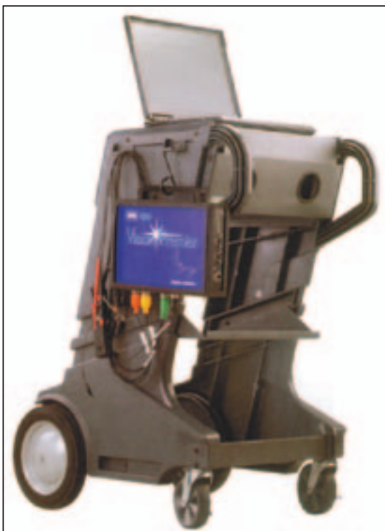
Мотортестер Vision Premier американской корпорации SPX — новейший мотортестер модульной конфигурации. Работает в комплексе со стандартным PC. В варианте с ноутбуком может использоваться как портативный. Мощный процессор, цветной дисплей, четырехканальный осциллоскоп. Опции — газоанализатор, стробоскоп, принтер. Основное отличие от «двадцатитысячников» — отсутствие экспертной системы.
