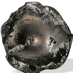
**Поломка клапана от больших механических перегрузок.**
