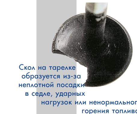
Скол на тарелке образуется из-за неплотной посадки в седле, ударных нагрузок или ненормального горения топлива.
