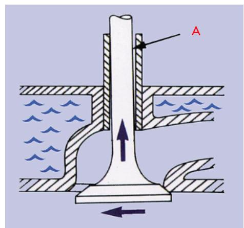
Быстрый износ направляющей втулки и стук клапана возникают и по другим, более сложным, причинам. Например, когда гнездо цилиндрического толкателя клапана несосно, либо имеет перекос по отношению к втулке. Подобный дефект иногда встречается на отечественных моторах. Стук возможен также из-за повышенных зазоров в деталях привода — в осях коромысел, в гнездах цилиндрических толкателей, а также в подшипниках распределительного вала.
