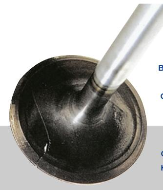
Сочетание ударных нагрузок с длительной работой двигателя на большой частоте вращения — причина образования радиальной трещины со сквозным отверстием в тарелке.
