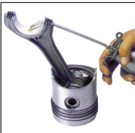
Перед сборкой вкладыши смазываются с помощью масленки. Другие способы смазки (кистью, пальцем и т.д.) неудачны, т.к. на поверхности вкладышей могут остаться посторонние примеси.
