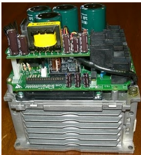
V7 - вид сбоку. Черный элемент на радиаторе - транзисторный блок.
