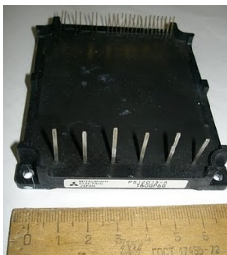
Транзисторный блок 2.2 кВт. Вид со стороны силовых контактов.
