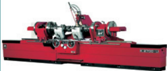
Одна из самых сильных сторон наших машин это то, что мы используем для станин чугун только высшего качества, а вес наших станков всегда превышает вес машин наших конкурентов. Другими словами, любая машина, сделанная AMC-SCHOU, более тяжелая, устойчивая, стабильная и, таким образом, более точная, чем другие станки аналогичных типов.
