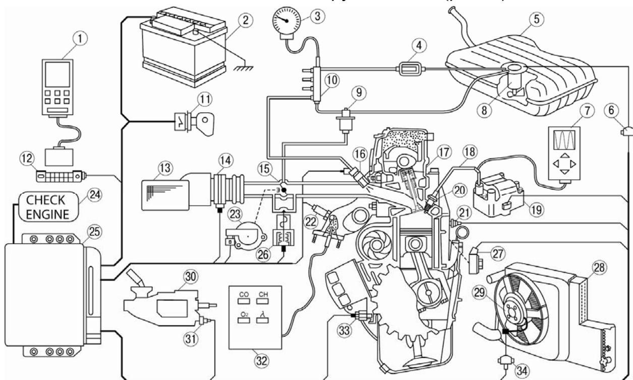
**Рис. 1. Принципиальная схема ЭСУД, устанавливаемая на двигатели автомобилей семейства ВАЗ с подключенным диагностическим оборудованием:**
