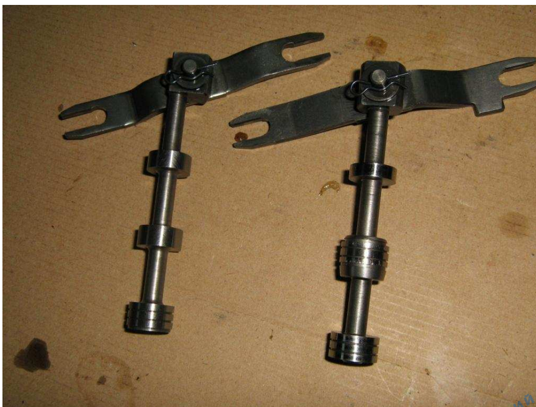
Фото 6 Серволинки изменения передаточных чисел CVT -2 и CVT – 1
