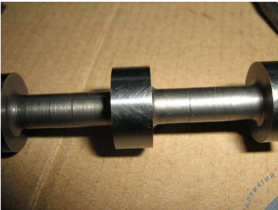
Фото 8 CVT-2 сечение плунжера.
