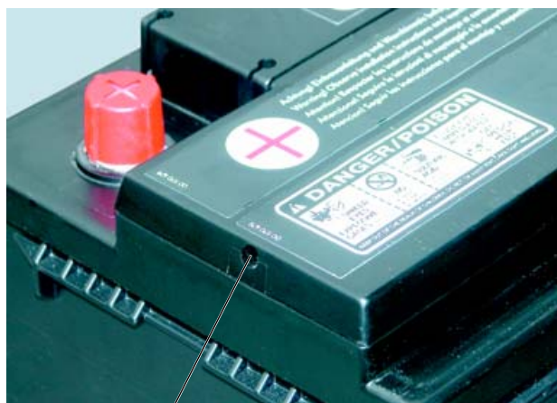
Отверстия центральной системы вентиляции
