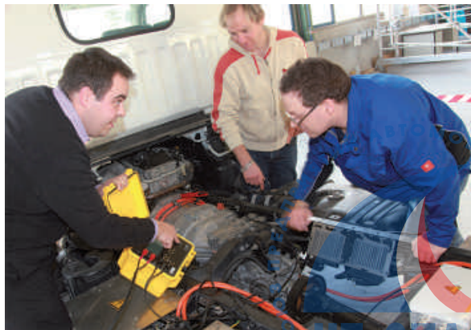
Харальд Дэмплфле (слева) объясняет, как выполнить измерение проводимости защитного проводника уравнивания потенциалов. Это необходимое условие для включения всей системы.
