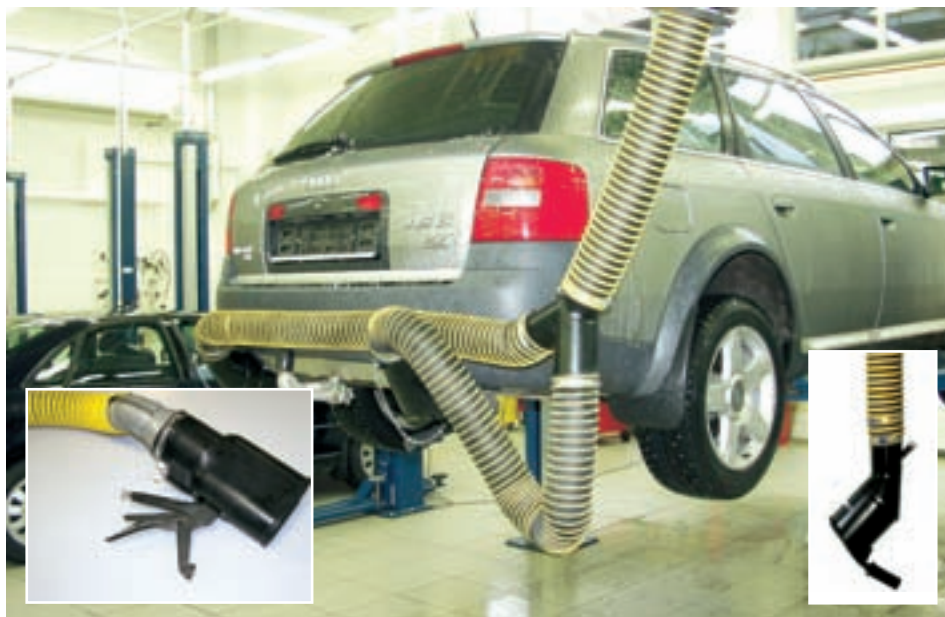
Предусмотрена возможность оснащения вытяжного шланга адаптерами и газоприемными насадками разной конструкции.
