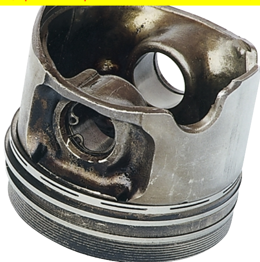
а) "родной" поршень имеет плавающий палец;
