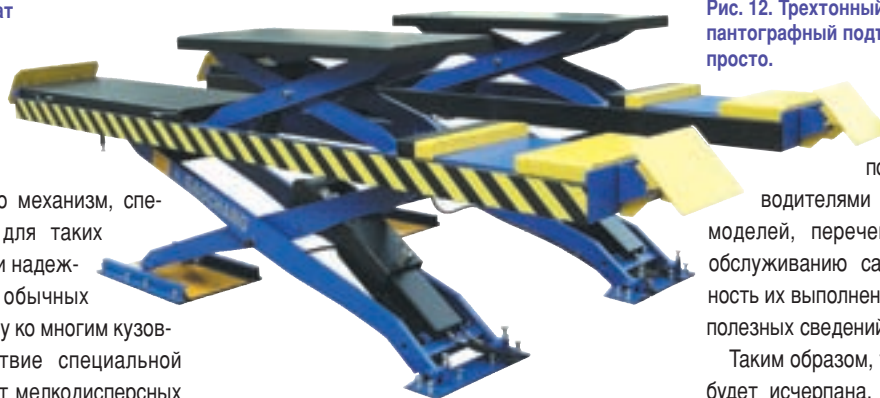
Рис. 13. Ножничный трапный подъемник с дополнительным оснащением для проведения «сход-развалных» операций
