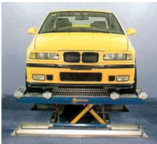
Рис. 14. Ножничный подъемник в кабине ОСК позволяет установить автомобиль в удобное для маляра положение.
