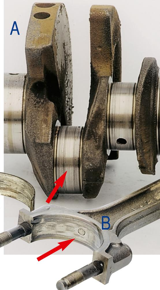
Задиры на шейках коленвала (А) и вкладышах (Б), нижние головки «пострадавших» шатунов (В) деформировались, а сапочные отверстия забились расплавленным рабочим слоем.
