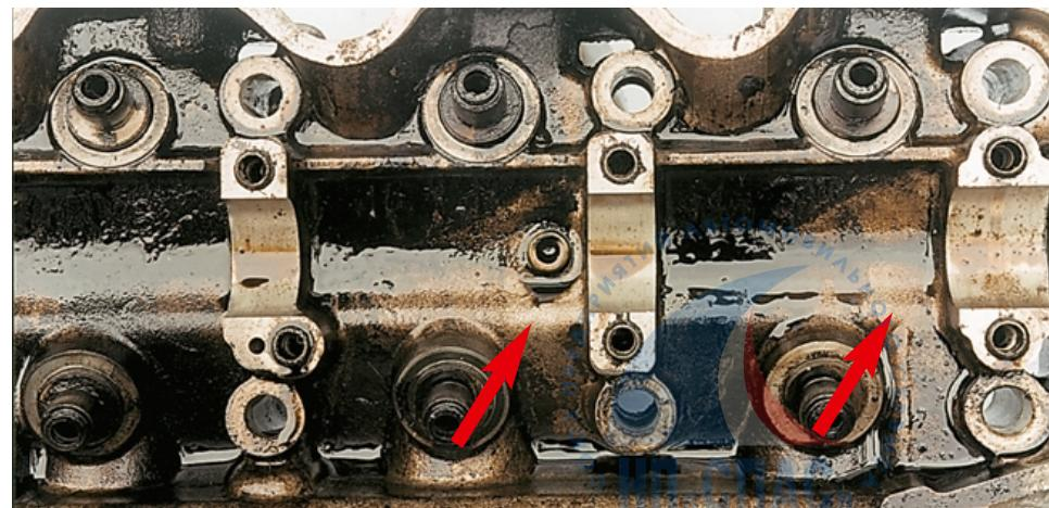
О том, что двигатель промывали, косвенно свидетельствуют «промытые» чистые участки на стенке головки блока цилиндров.
