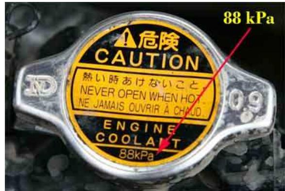
Фактически перегрев происходит из-за отсутствия охлаждающей жидкости в системе. Крышка радиатора - одна из причин.
