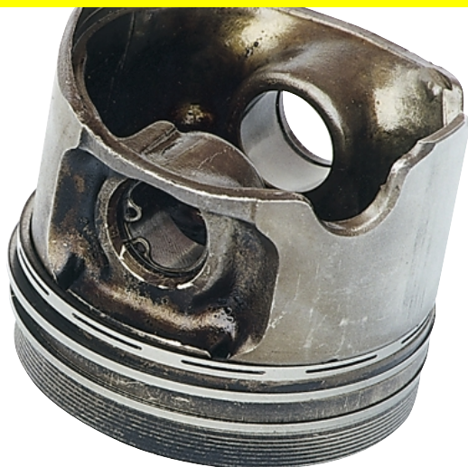
а) "родной" поршень имеет плавающий палец;
