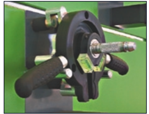
«Время — деньги». Следуя этому девизу, Bosch разработал и запатентовал магнитную систему крепления измерительной головки к колесу.
