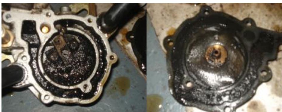
Рис. 4. Испаритель и мембрана газового редуктора, загрязненные смолистыми и маслянистыми отложениями
