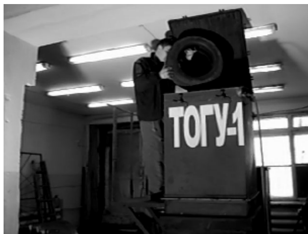
Фотография 2. Процесс загрузки бункера газогенератора
