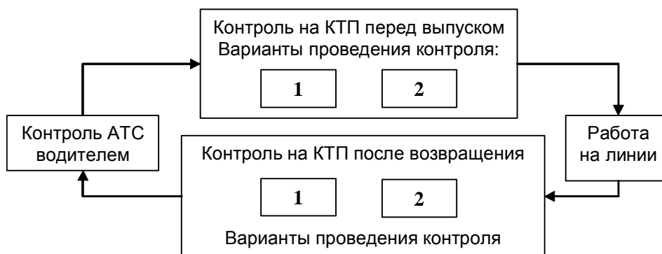
Рис. 1. Общая схема организации контроля технического состояния АТС на автотранспортном предприятии перед выпуском на линию и по возвращении с линии
