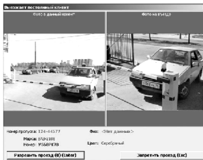
Рис. 3. Интерфейс программы автоматизированной системы парковки
