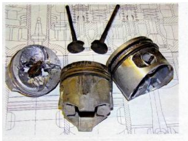
Рис. 3. Детали цилиндропоршневой группы и газораспределительного механизма, вышедшие из строя по причине некачественного топлива
