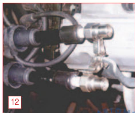
Искровой разрядник (фото 12) — это средство экспресс-диагностики систем зажигания всех типов и конструкций. Оно позволяет быстро установить, насколько эффективно система накапливает и отдает энергию. Проверка искровым разрядником носит комплексный характер, результат интерпретируется на уровне «работает — не работает». В случае неисправности для поиска причины
