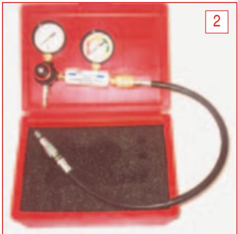
Помимо соответствия повышенным требованиям прочности и надежности соединений хороший тестер оснащается надежным редуктором для плавной регулировки давления нагнетания. В комплект входят адаптеры для различных типов свечных отверстий. Шкалы манометров имеют удобно читаемую градировку. Для обеспечения достаточной чувствительности прибор должен быть рассчитан на максимальное рабочее давление 6-7 бар.
