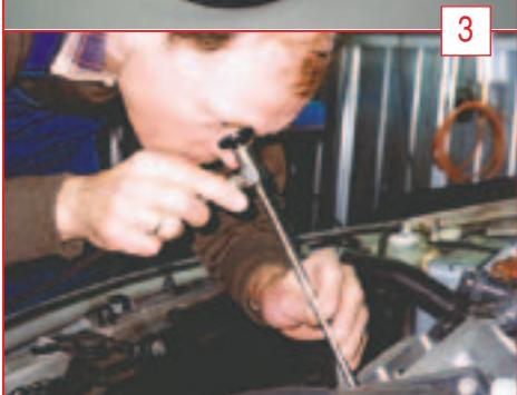
позволяет без труда разобрать двигатель с абсолютной достоверностью сделать заключение о степени износа стенок цилиндров, величине нагара, степени повреждения днища поршней или поверхностей клапанов. Эндоскоп также с успехом применяют для наружного обследования двигателя и навесного оборудования в труднодоступных местах.
