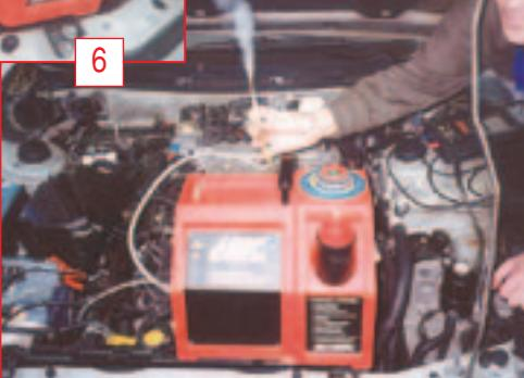
Как видите, принцип прост и оригинален, а результаты очень эффективны. Из альтернативных методов можно упомянуть обработку на работающем двигателе подозрительных мест специальными спреями, соляркой или бензином. Попадание их паров вместе с засасываемым воздухом в двигатель вызывает повышение его оборотов, что и сигнализирует о наличии подсо-
