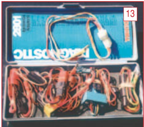
В современных системах зажигания первичное напряжение на катушку зажигания часто подается через разъем, а не на открытые клеммы. В этом случае при снятии характеристик зажигания и при определении баланса мощности по цилиндрам возникает проблема доступа к контактам первичной цепи. Прокалывание изоляции проводов булавкой не всегда обеспечивает достаточно надежный контакт и грозит коротким замыканием с тяжелыми последствиями.
