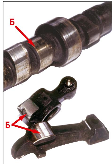
Износ любой из деталей распределительного механизма (места Б) вызывает стук с частотой, вдвое меньшей частоты вращения.
