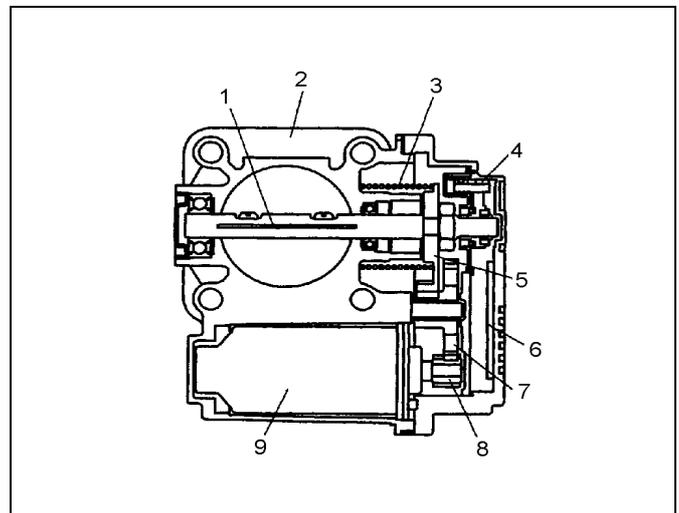
1 - дроссельная заслонка, 2 - корпус дроссельной заслонки, 3 - возвратная пружина, 4 - датчик положения дроссельной заслонки, 5 - шестерня привода заслонки, 6 - цепь управления, 7 - промежуточная шестерня, 8 - ведущая шестерня, 9 - электродвигатель привода заслонки.
