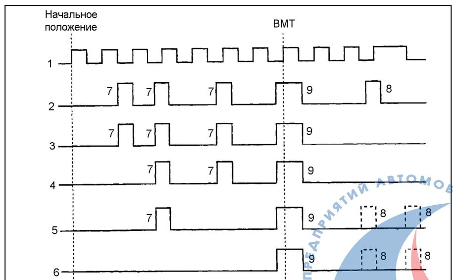
Управление количеством впрысков топлива. 1 - сигнал датчика положения коленчатого вала, 2 - пять впрысков, 3 - четыре впрыска, 4 - три впрыска, 5 - два впрыска, 6 - один впрыск, 7 - пилотный впрыск, 8 - послевпрыск, 9 - основной впрыск.
