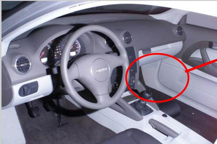
Доступ к противопыльцевому фильтру в днище справа от водителя
