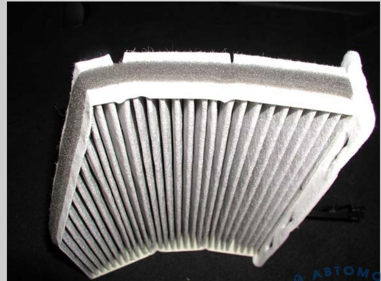
Для монтажа/демонтажа фильтровальный элемент имеет два места сгиба и заваренную ультразвуком **вынимающуюся накладку** на нижней стороне
