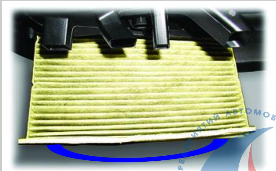
Монтаж/демонтаж противопыльцевого фильтра с помощью вынимающейся накладки (помечена синим)
