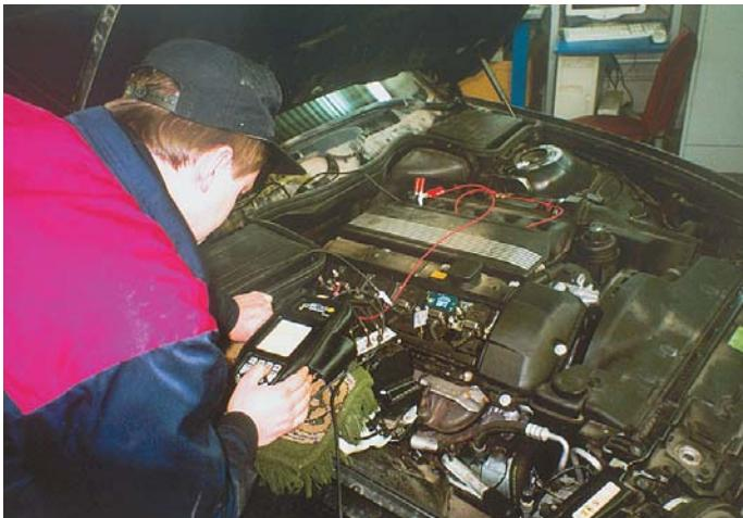
PDA-2100 можно с успехом использовать для исследования различных систем зажигания, включая системы с индивидуальными катушками.
