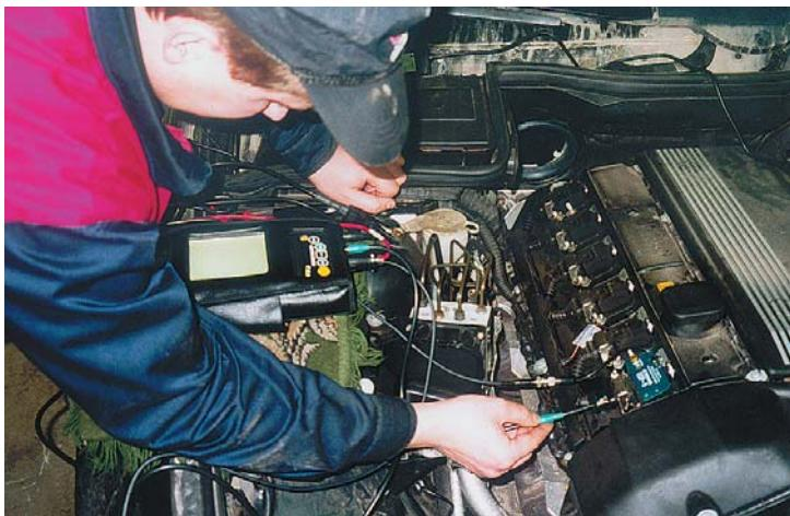
Закрепленный на корпусе катушки датчик соединяется с кабель-адаптером. Через другой кабель в мотортестер подается сигнал в первичной цепи.
