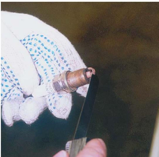
Изолятор и электроды свечи во втором цилиндре — в прекрасном состоянии, а вот межэлектродный зазор подкачал.
