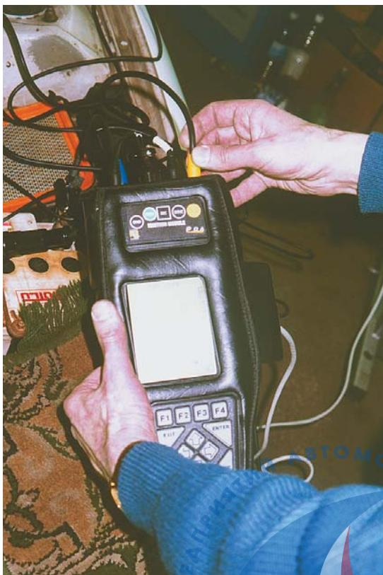
Чтобы превратить мотортестер в осциллограф, достаточно к разъему пристыковать измерительный кабель и выбрать соответствующий режим в меню осциллографа.
