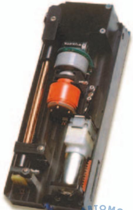
Измерительный блок американской фирмы Andros, несмотря на небольшие размеры, содержит все необходимое для определения концентрации пяти компонентов выхлопа: спектрометрический узел и два электрохимических датчика с платой питания. Размеры миниатюрные, а стоимость, как у большого!
