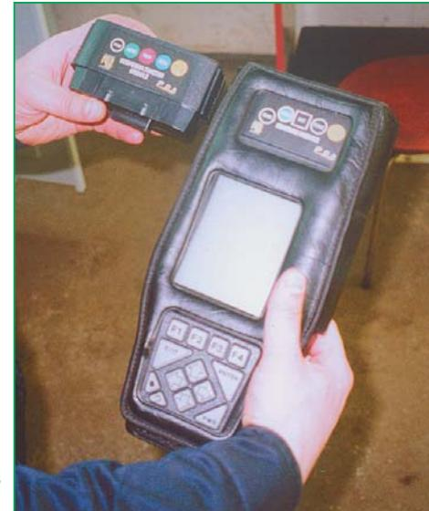
«База» мотортестера комплектуется сменными модулями, один — для проверки системы зажигания, другой — для работы в режиме 4-х канального осциллографа.
