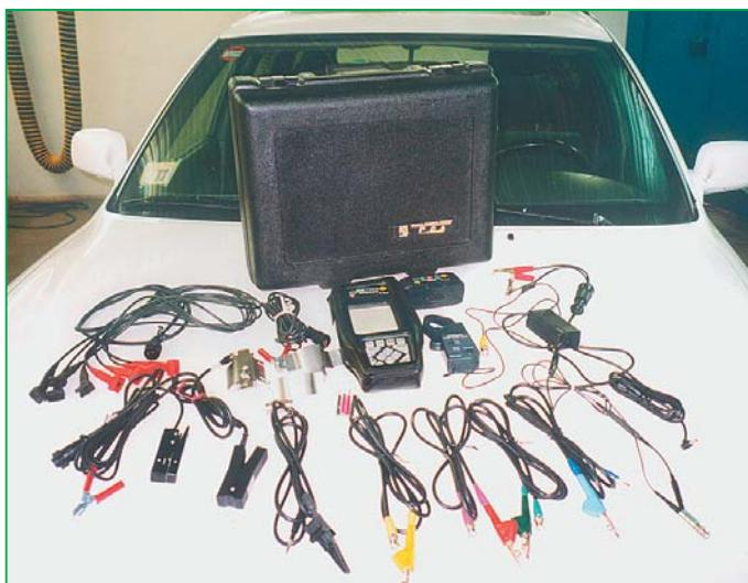
Для работы с системами, где высоковольтная катушка встроена в распределитель, комплект содержит 4 типа емкостных датчиков.
