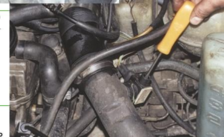
Обороты холостого хода регулируют винтом, расположенным на корпусе дроссельной заслонки.
