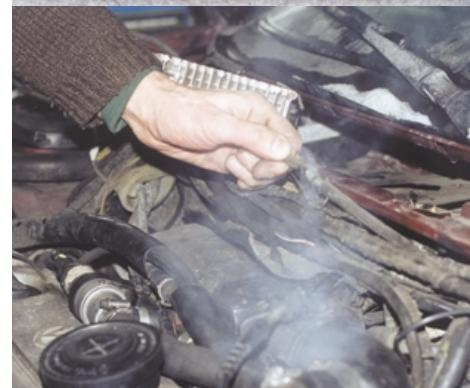
Прибор Leak Check позволяет быстро проверить герметичность различных систем. Было обнаружено повреждение шланга MAP-сенсора.
