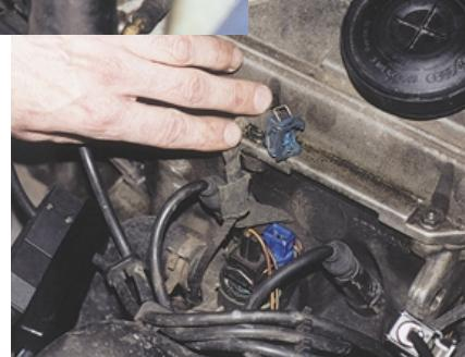
Чтобы перевести систему управления в режим базовых настроек, отсоединяют разъем датчика температуры двигателя. Трижды подняв обороты выше 3000 мин<sup>-1</sup>, приступают к регулировкам.
