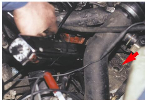
Перед началом регулировок, используя стробоскоп, корректируют угол опережения зажигания. Метки, нанесенные на маховике, подсвечиваются через окошко в картере.
