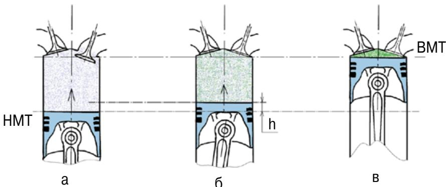
**При движении поршня из нижней мертвоточки (а) давление начинает повышаться только после закрытия впускного клапана (б) и достигает максимума в верхней мертвоточке (в):
