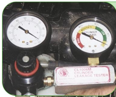
Аккуратным простукиванием впускных клапанов с одновременной подачей в камеру сгорания сжатого воздуха удалось восстановить ее нормальную герметичность. Это подтвердилось повторным замером утечек.
