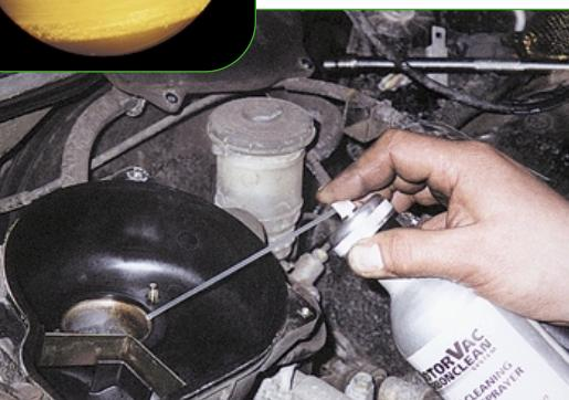
«Химчистка» впускного тракта проводилась через открытый воздуховод дроссельного устройства. Для подачи сольвента использовался простой в эксплуатации многоразовый баллончик-спрейер. Результат вызвал чувство удовлетворения.
