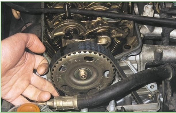
Проверка правильности регулировки газораспределительного механизма опровергла первое предположение о причине падения компрессии.
