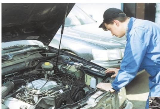
Без пластиковых накладок двигатель смотрится не так изящно, зато хорошо видны некоторые его особенности. Перед сплетением труб впускного коллектора — три двухискровых катушки DIS-зажигания.
