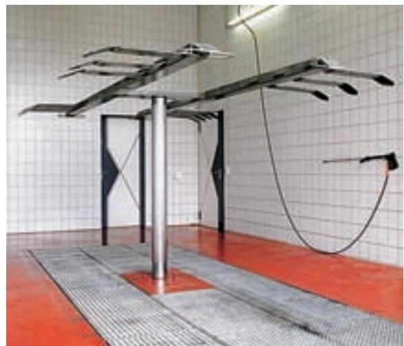
Рис. 2. Гидравлический плунжерный подъемник для участка мойки
