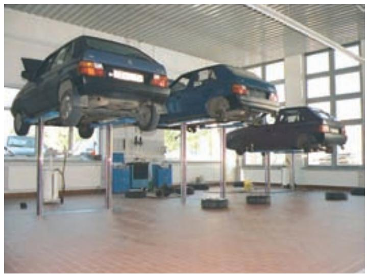
Рис. 10. Дуэт. Плунжерные подъемники с двумя штоками
