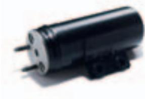
Осушитель, расположенный между конденсатором и регулятором давления, предназначен для удаления влаги из хладагента, а также для его очистки от загрязнений. Зачастую осушитель одновременно является резервуаром для хладагента. В некоторых случаях в качестве резервуара для хладагента используется испаритель.
