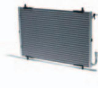
Конденсатором называют теплообменник, расположенный в передней части автомобиля. Он охлаждается потоком воздуха, образующимся за счет движения автомобиля, или с помощью вентилятора (например, если автомобиль неподвижен). В конденсаторе происходит сжижение хладагента.
