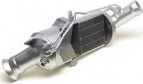
Сажевый фильтр (FAP, DPF) - это устройство задерживающее сажевые частицы, содержащиеся в выхлопных газах дизельных двигателей последних поколений. Сам фильтр представляет собой небольшую емкость с пористым заполнителем из керамики. В зависимости от модели конструкция его бывает двух видов, как отдельный компонент выпускной системы, так и в комбинации с каталитическим нейтрализатором.
