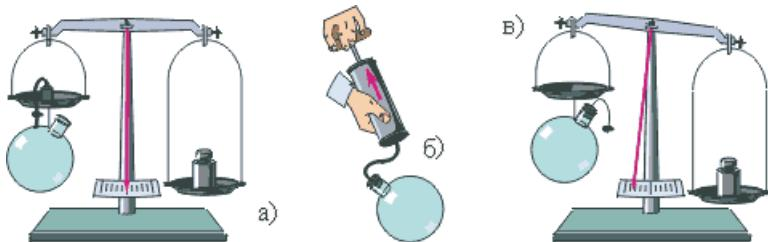
Взгляните на рисунок "б". Шар отцепили от чаши и присоединили к насосу. Некоторое время воздух из шара откачивали. Затем трубку пережали зажимом, а шар опять подвесили к чаше (рис. "в"). Мы видим, что теперь гиря "перевешивает", следовательно, масса шара меньше массы гири. Другими словами, воздух обладает массой!
