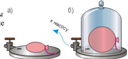
Воздух внутри шарика постоянно давит на его оболочку изнутри. Но и воздух вокруг шарика давит на его оболочку – снаружи. Откачивая воздух из-под колокола, мы уменьшаем наружнее давление. В результате внутреннее давление и "раздувает" оболочку сильнее.
