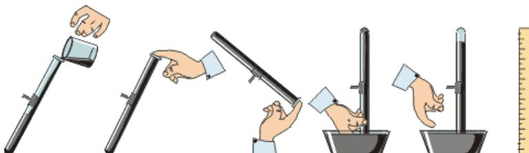
Стеклянную трубку длиной около метра, запаянную с одного конца, наполняют доверху ртутью. Затем, плотно закрыв отверстие пальцем, трубку переворачивают и опускают в чашу со ртутью. После этого палец убирают. Ртуть из трубы начинает выливаться, но не вся! Остается ее "столбик" примерно 76 см высотой (считая от уровня ртути в чаше). Примечательно, что эта высота не зависит ни от длины трубы, ни от глубины ее погружения в ртуть.
