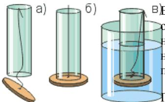
Возьмем стеклянную трубку и легкий диск на нити (рис. "а"). Натянув нить, мы получим сосуд с отпадающим дном (рис. "б"). Погрузим этот сосуд в стакан с водой. Теперь дно не отпадет, даже если нить не натягивать (рис. "в"). Так происходит потому, что верхние слои воды в стакане создают давление на нижележащие слои, в том числе и на слой воды под диском. Согласно закону Паскаля давление передается через этот слой и действует на диск снизу вверх.
