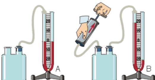
В манометре на правую поверхность воды действует атмосферное давление, а на левую поверхность – меньшее давление. Под действием неравенства давлений, то есть неуравновешенных сил, вода и смещается влево.
