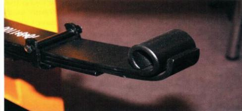
От прочности коренного листа зависит эксплуатация автомобиля на плохих дорогах.
