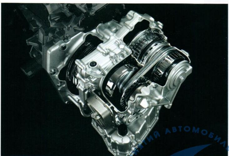
ного блока, так и механической части: конусов и цепи. Начинаются неполадки в электронном блоке – возникают и сбои в гидравлическом управлении, в результате повышается температура масла – происходит перегрев ЭБУ, он дает сбой за сбоем, температура масла возрастает, в итоге совершенно неисправный агрегат.
