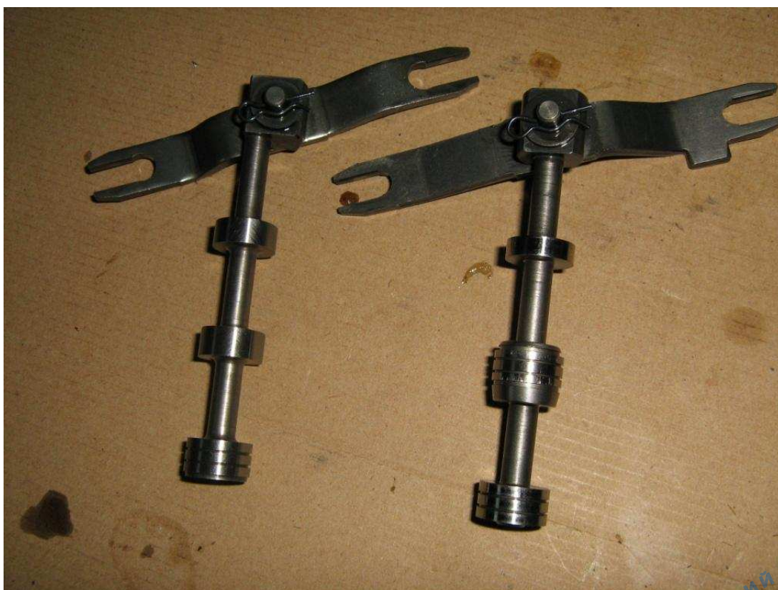
Фото 6 Серволинки изменения передаточных чисел CVT -2 и CVT – 1
