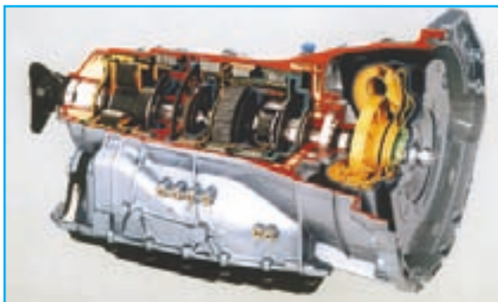
Родоначальница 6-ступенчатого семейства коробок ZF — модель 6HP 26. Ряд из шести гармоничных ступеней получен минимальными средствами: двумя планетарными рядами с пятью управляющими элементами.
