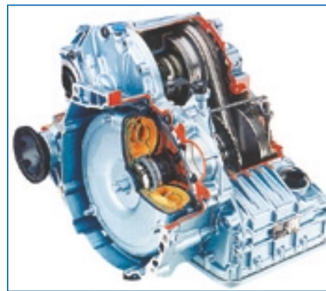
В конструкции БСТ Ecotronic, предназначенных для передачи больших крутящих моментов, в качестве приводного устройства используется гидротрансформатор. Это повышает плавность троганья с места и проходимость автомобиля, уменьшает динамические нагрузки на вариатор.
